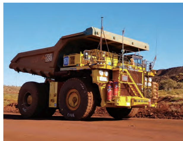
AHS改造後付キットを搭載し無人稼働する830E（場所：豪州Rio Tinto社鉄鉱山）
