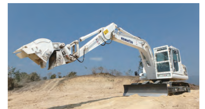
油圧ショベルをベースに開発された対人地雷除去機(不発弾処理用)
