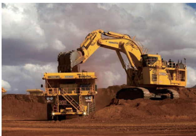
AHSで管理、運行されている無人ダンプトラック
