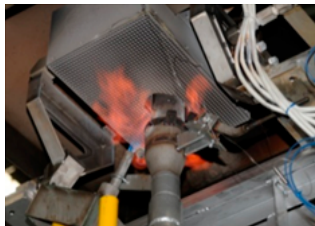
浸炭炉での熱電発電の例
