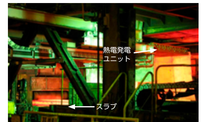
連続鋳造機での実証試験例 (JFEスチール(株) 殿ご提供)
