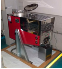
金沢工場の溶剤回収装置
