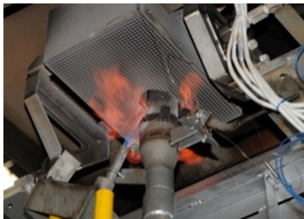
浸炭炉での熱電発電の例
