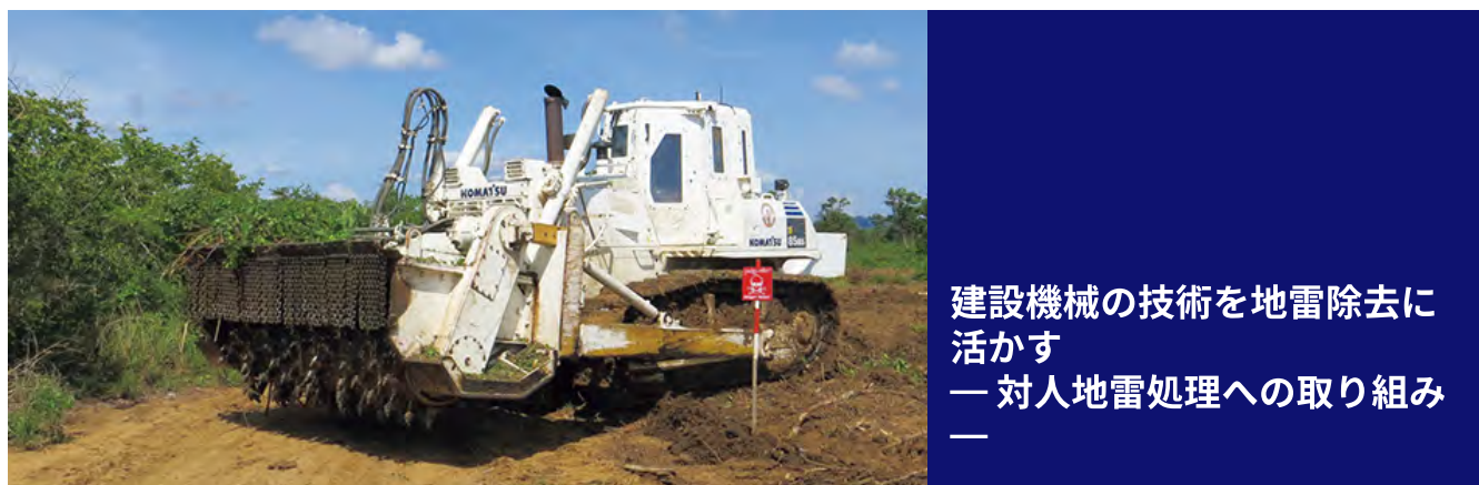
アフガニスタンでフィールド試験中のコマツ対人地雷除去機D85MS
