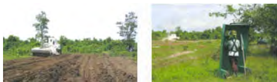
（左）コマツの対人地雷除去機はツメのついたローラー（カッター）を回転させ、地中の対人地雷を破碎・爆砕します。広い面積を移動しながら灌木や雑草を破碎し、あたたかみ畑のような土地に変えていきます（2006年、カンボジアにて）。 （右）無線操作の訓練（カンボジア）。作業者は防護楯の陰から操作します。
