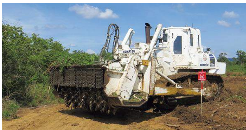
アフガニスタンでフィールド試験中のコマツ対人地雷除去機D85MS
