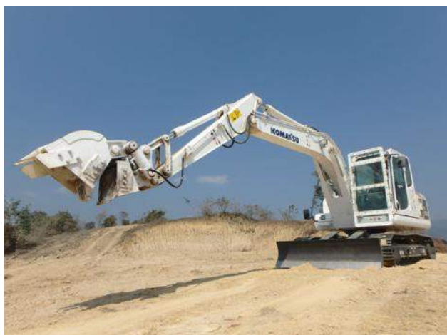
油圧ショベルをベースに開発した対人地雷除去機（不発弾処理用）
