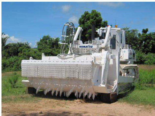
ブルドーザをベースに開発した対人地雷除去機
