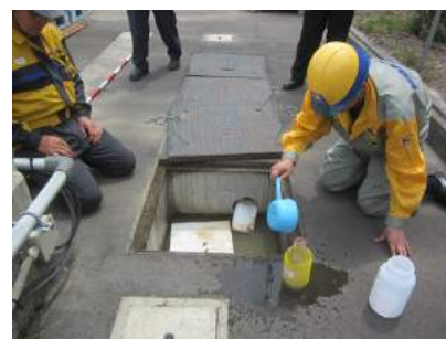
油水分離槽の水質調査の状況
