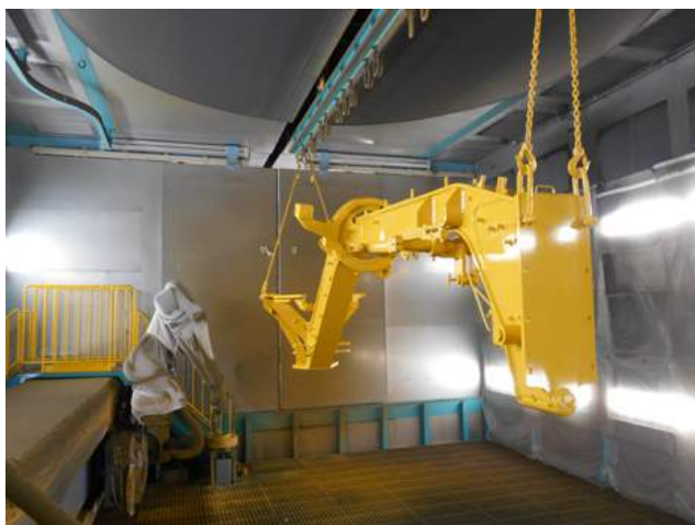
塗装ロボットによるフレーム塗装
