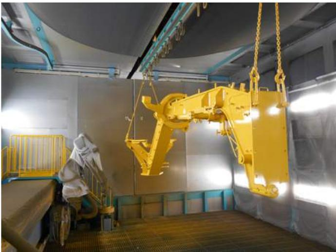
塗装ロボットによるフレーム塗装
