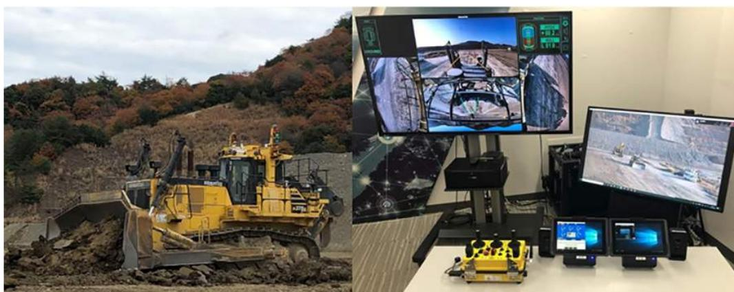
商用5Gを利用した鉱山向け大型ICTブルドーザー「D375Ai-8」の遠隔操作 左：大分県にあるブルドーザー 右：東京都に設置された遠隔操作卓
