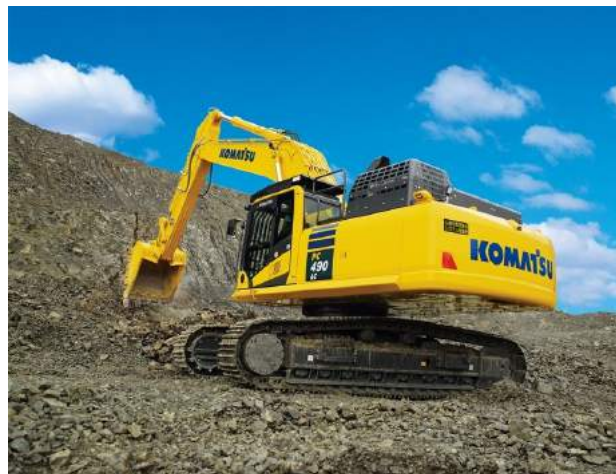
2022年からKomVision人検知衝突警報システムを搭載したPC490LC-11
