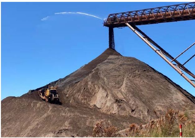
導入鉱山でストックパイルオペレーションを行う遠隔操作ブルドーザー
