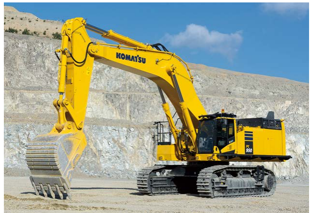
KomVision（機械周囲カメラシステム）を標準装備したPC950-11
