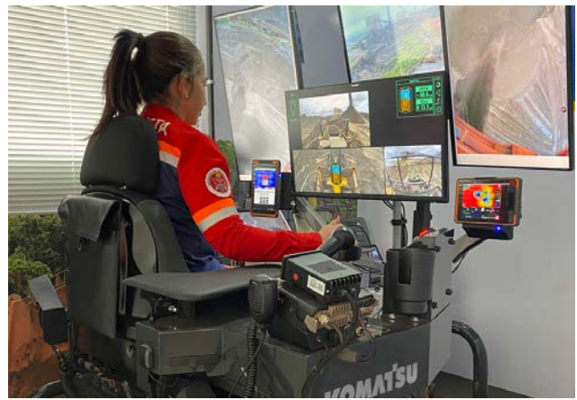
オペレーターの操作感を損なわない「遠隔操作室」
