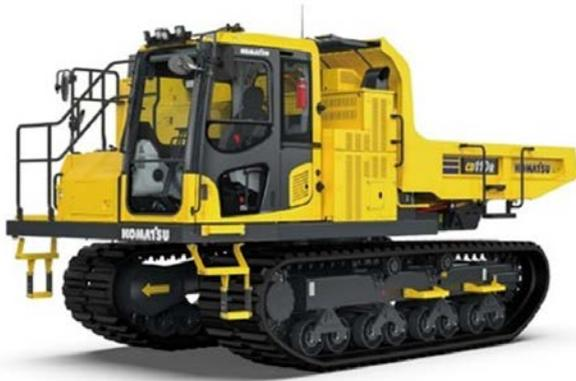
車両転倒警報システムを搭載したCD110R-3
