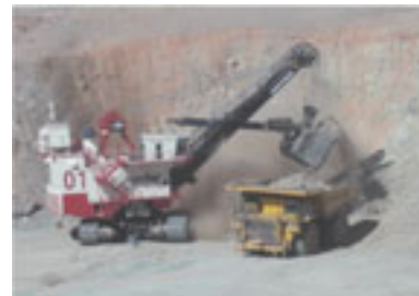
300tの銅鉱石が積み込まれる無人ダンプトラック
