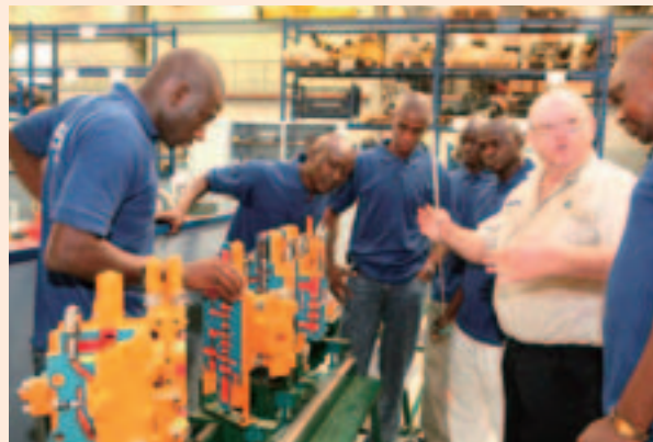
ダカール トレーニングセンタの様子。トレーニングは1期1クラス6名で行われる。油圧バルブのカットモデルで、構造機能の説明を行っている様子。
