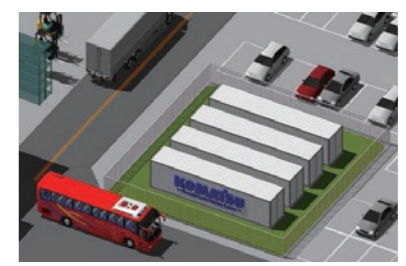
フォークリフト用のメンテナンスフリーバッテリーを使った大規模蓄電システム
