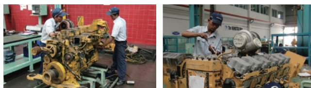
(左) 使用済みコンポーネントを分解する。 (右) 厳正な検査・洗浄・加修を経て、再組立を行う。この後、性能検査・塗装・出荷検査を経て、出荷される。
